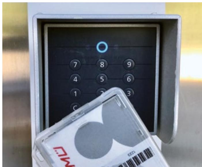
Die Leser im Außenbereich verfügen zum Schutz gegen die Witterung über eine Heizung und ein Dach.
